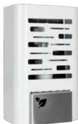
Le désinsectiseur MASK est silencieux et sans odeurs. Il doit être installé dans une zone sombre afin d'éviter l'interférence de sources de lumière proches. Fixation murale à une hauteur de 2,20 m maximum. Remplacement annuel de la lampe. Remplacement des plaques de glu tous les 2 mois.
