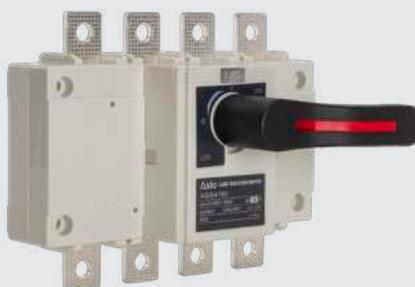
L'interrupteur-sectionneur ASLO est un dispositif électrique qui peut être utilisé pour un courant AC 50/60 Hz et une tension nominale inférieure à 660 V (690 V). Il s'applique également au DC avec une tension nominale inférieure à 440 V. Son courant nominal est de 160 A ~ 630 A. Il permet de produire et de couper le courant du circuit électrique ou de fournir une tension d'isolement électrique dans le système d'énergie. Ce produit est conforme à la norme IEC60947-3.
