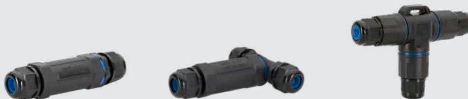
La gamme de connecteurs haute protection IP68 ASLO ELECTRIC est idéale pour une utilisation dans les environnements exigeants (poussière et humidité). Ces connecteurs possèdent des bornes de raccordement internes à 3 ou 5 pôles, adaptées aux conducteurs ayant une section entre 0,5 et 2,5 mm<sup>2</sup>.
