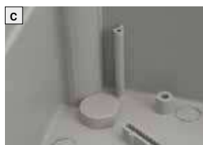
Tapones de protección para garantizar la estanqueidad y clase de aislamiento
