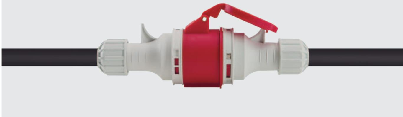
Um dispositivo em aço niquelado facilita a abertura e o fecho das fichas, agilizando o tempo de conexão. Para a abertura, é unicamente necessário exercer uma ligeira pressão no dispositivo, através de uma chave de fendas, ao mesmo tempo que é possível fechar com uma simples rotação do corpo.
