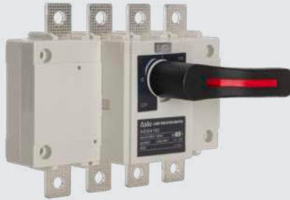
O interruptor seccionador da ASLO é um dispositivo elétrico adequado para AC 50/60Hz, tensão nominal inferior a 660V (690V). O interruptor seccionador também se aplica a CC, tensão nominal inferior a 440V. A sua corrente nominal é de 160A~630A. É adequado para produzir e interromper a corrente do circuito elétrico ou para efeitos de isolamento elétrico no sistema de energia. Este produto está em conformidade com a norma IEC60947-3.
