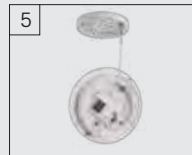
5 Possibilité d'ouvrir le plafonnier déjà fixé en place
