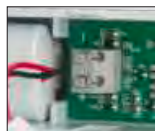
Connexion pour télécommande
